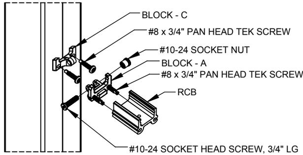
③ TYP. BOTTOM RAIL HINGE JOINT
