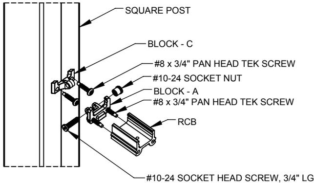
3 TYP. BOTTOM RAIL HINGE JOINT CONNECTION
