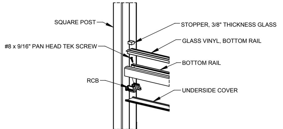
3 TYP. BOTTOM RAIL HINGE JOINT CONNECTION
