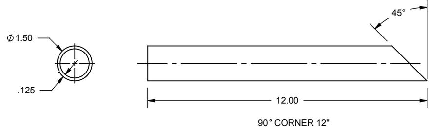
PARTS ARE MADE FROM "HDRL-LK-00" EXTRUSION
